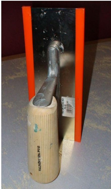
25.3 pav. Trintuvė PV 43 su apsauga
